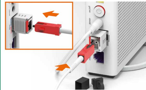
Vous devez d'abord retirer avec précaution les embouts noirs, ainsi que l'embout présent sur le port «fibre».
