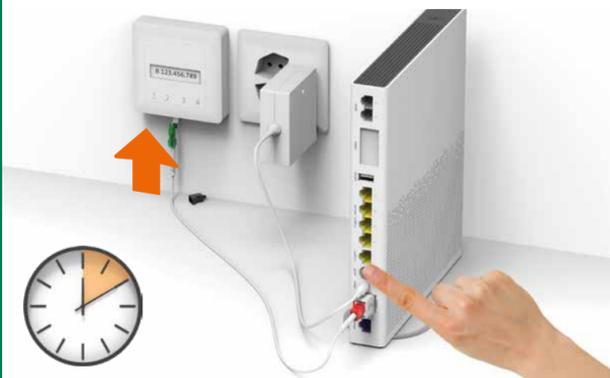
Sur la prise fibre optique, utilisez l'emplacement 2 comme indiqué dans le SMS. C'est celui qui fonctionne le plus souvent – dans de rares cas, il faut utiliser l'emplacement 1.
